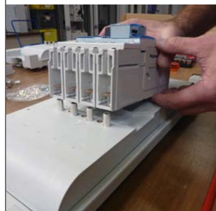
Mettre en place de l'appareil sur la partie mobile de la base.
