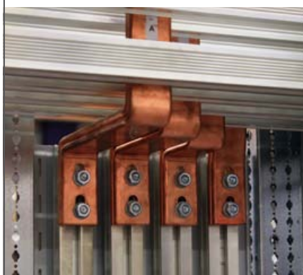
Montage du kit de raccordement réf. 4 046 93. Couples de serrage : 50 N · m
