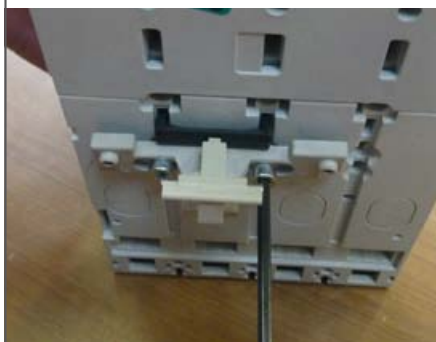
Fixer la bascule par les deux vis fournies (couple de serrage 1 N·m).
