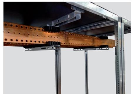
Pour réaliser un jeu de barres principal horizontal en fond d'enveloppe (prof. 600 ou 800 mm), les supports fixes réf. 3 399 29 s'installent sur les traverses de la même manière que les montages expliqués ci-dessus. Cependant, les supports seront toujours équipés avec la grande glissière en position « fixation 600 mm » (voir photo page 12).
