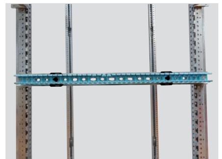
Il est également possible de fixer la goulotte directement sur les montants arrière en utilisant les rivets isolants réf. 0 200 80.
