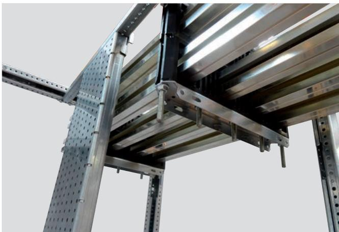
Pour réaliser un jeu de barres principal horizontal en fond d'enveloppe (prof. 600 ou 800 mm), le support fixe réf. 3 399 20 s'installe sur les traverses de la même manière que les montages expliqués ci-dessus. Dans le cas d'une répartition avec barres aluminium en C supérieure à 1600A (3200A maxi.), deux jeux de barres sont placés l'un au-dessus de l'autre dans la hauteur des enveloppes.
