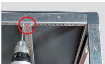
Positionner les 4 pattes de fixation (2 en haut et 2 en bas) au même niveau latéral que les trous rectangulaires présents à l'arrière des traverses : attention au sens (voir photo). Fixer ces 4 pattes à l'aide des vis auto-taraudeuses fournies (1/patte) → embout Torx T30, couple de serrage de 8 N.m.
