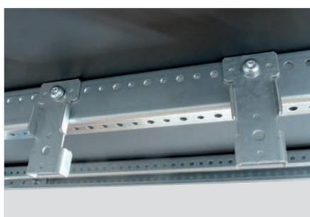
Mettre en place le montant central dans les pattes de fixation puis le fixer à l'aide des vis auto-taraudeuses fournies (1/ patte) → embout Torx T30, couple de serrage de 8 N.m.
