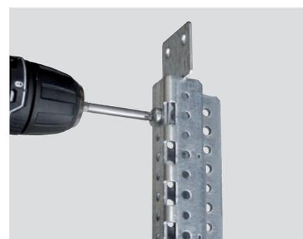
Fixer les 2 ensembles montant-patte sur la structure de l'enveloppe : 2 vis/patte.
