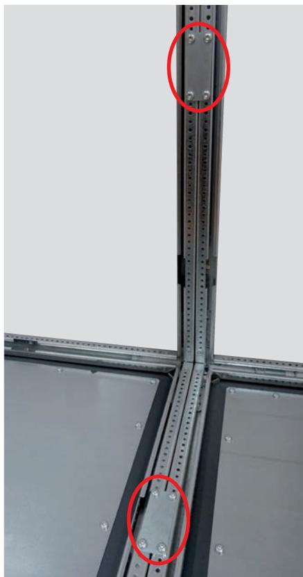
La fixation des vis s'effectue à l'aide d'un embout Torx T30, le couple de serrage est de 8 N.m.
