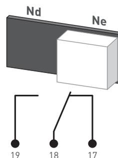
Position des contacts en condition d'appareil alimenté.
