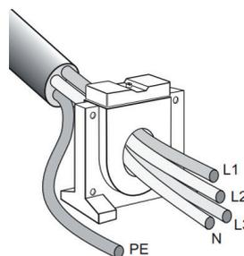
Cas 2 - Par câble 5G par exemple, dans le cas où le PE passe dans le tore, alors ce conducteur doit être remis dans le sens inverse pour régulariser le champ comme l'image ci-dessous.
