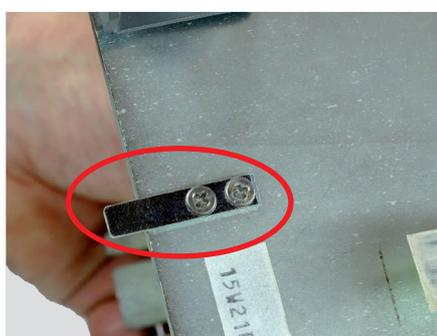
Mettre le bloc verrouillage dans l'emplacement prévu, et serrer avec la vis fournie :
