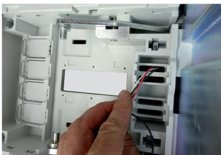
Faire passer les fils du contact dans le trou prévu de la base puis insérer le contact dans l'emplacement dédié en respectant le sens :
