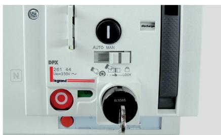
**i** Pour verrouiller, il est nécessaire d'appuyer sur le bouton rouge « 0 » puis tourner la clé en position verticale. Pour déverrouiller, il faut appuyer sur le bouton rouge « 0 » puis tourner la clé en position horizontale.
