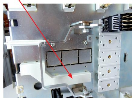
Emplacement des fils (suivant les accessoires montés) détaillé page 20 de la notice du mécanisme débro-lift référence 4 225 93/94.
