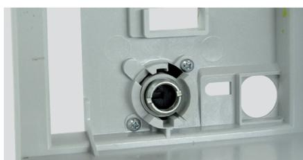
6. Position de la clé horizontale → la clé ne peut pas être enlevée et le moteur n'est pas verrouillé.
