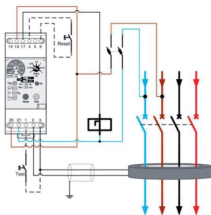
Avec bobine à manque de tension :
