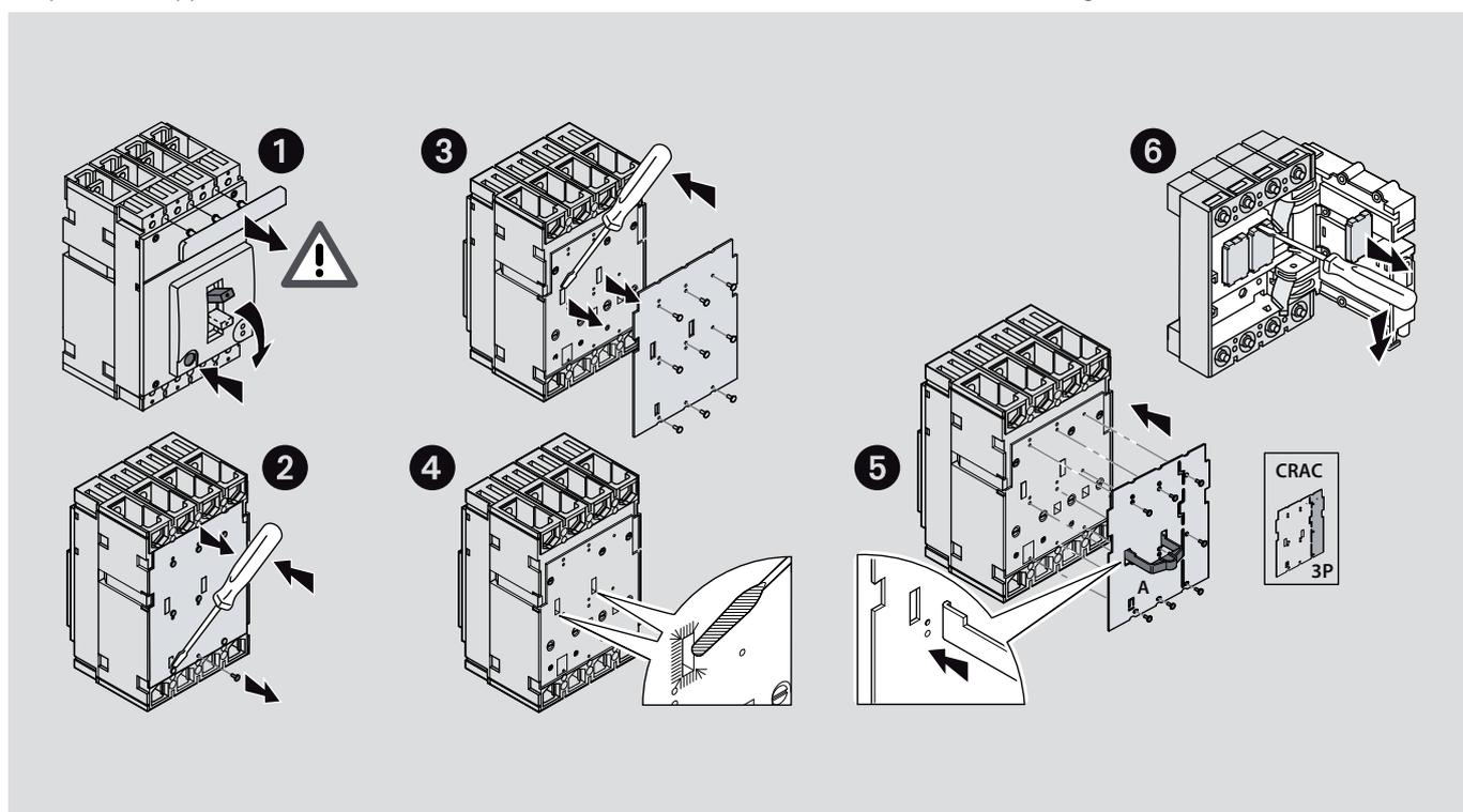
Mettre en place l'interverrouillage mécanique selon les illustrations ci-dessous :
