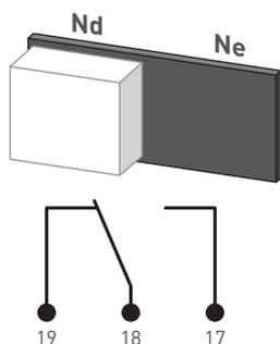
Position des contacts en condition d'appareil alimenté.
