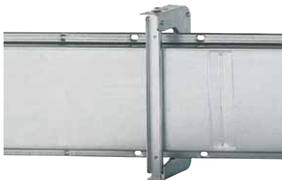
Les supports doivent être disposés tous 2 mètres
